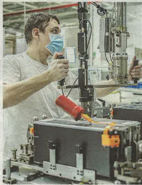
Elettrico Un operaio addetto al montaggio di accumulatori
